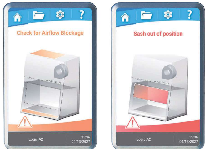
Sash Alarm display on Logic OS.
