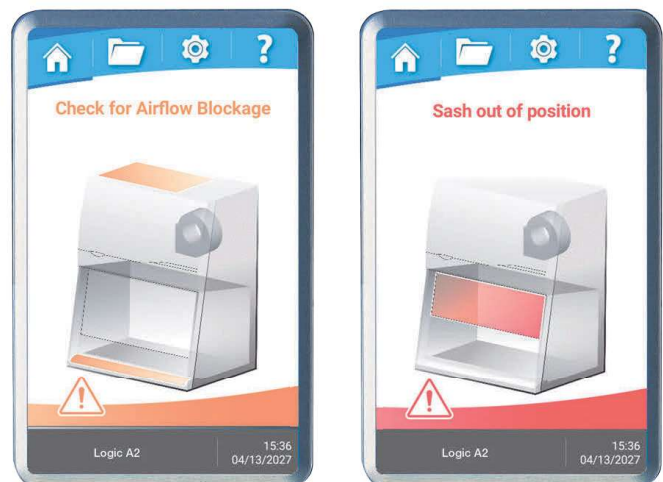
Sash Alarm display on Logic OS.
